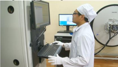
Tủ điều khiển đánh giá tuổi thọ Led, ứng dụng tại Rạng Đông. Ảnh: Rạng Đông
